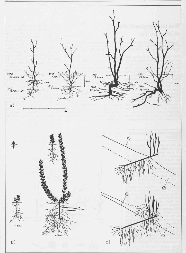
Bild 2 a-c. Verschüttungsresistenz und Wuchsleistung; a Überschotterung von Grauweiden im Laufe von zehn Jahren (nach Schiechtl); b Wuchsleistung von Berberis - oben aus Saat, unten aus Steckholz - im 1. und 2. Jahr (nach Schiechtl); c Minderung der Erosion durch Weidenbuschlagen (nach Schlüter)
