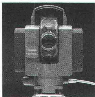
Das Bild zeigt den motorisierten Präzisionstheodolit Kern E2-SE «in Aktion». Mit seinen durch Schrittmotoren angetriebenen
