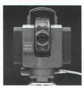
Das Bild zeigt den motorisierten Präzisionstheodolit Kern E2-SE «in Aktion». Mit seinen durch Schrittmotoren angetriebenen Achsen und der im Fernrohr eingebauten CCD-Kamera wird dieses neue, auf dem Prinzip des Kern E2 aufgebaute Winkelmessgerät, zum Messroboter.
