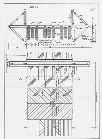
Bild 4. Schnitt und Aufsicht auf die Spannband-Konstruktion mit Brückengeländer
