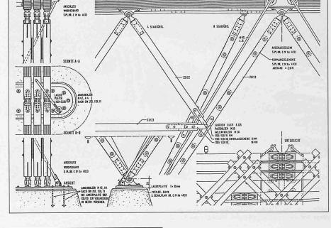
Bild 3. Detail der Dreiecks-Zwischenpfeiler aus Holz
