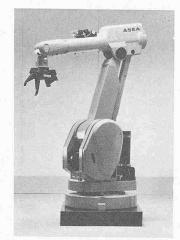
пеце Asea-Industrieroboter IRB 3000 mit einer Tragfähigkeit von 30 kg und einer Reichweite von 1,95 m. (Werkbild Asea)
