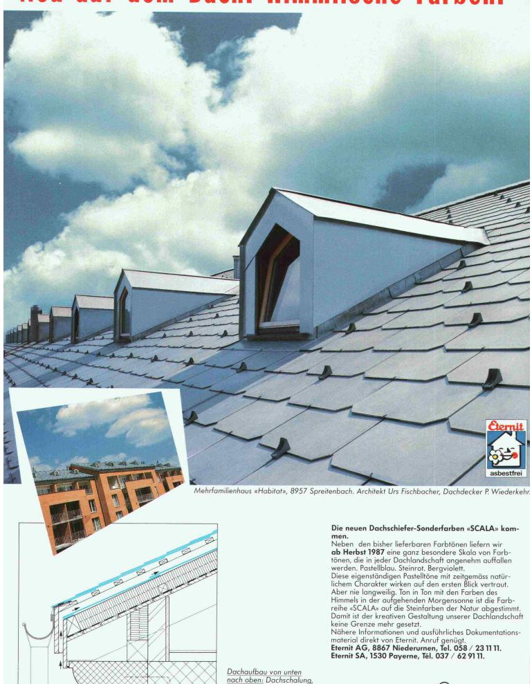
Dampfsperre, Wärmedämmung, GEA-Unterdach, Konterlattung, Lattung, Dachschiefer 60/40 cm in Doppeldeckung,
