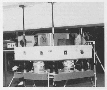
Bild 2. Schwingungs-Tilger im Demonstrationsversuch
