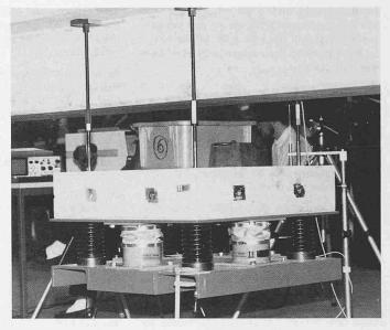
Bild 2. Schwingungs-Tilger im Demonstrationsversuch
