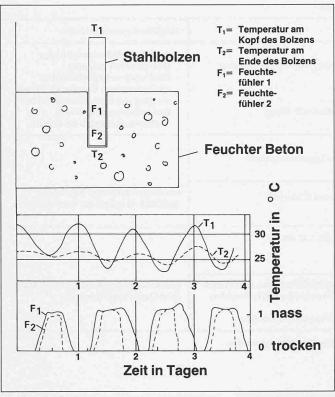
Bild 1. Modellversuch zum Nachweis der Kondenswasserbildung im Bohrlochbereich
