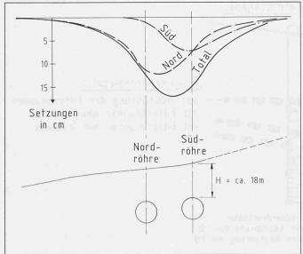
Bild 10. Messquerschnitt mit den grössten Setzungen
