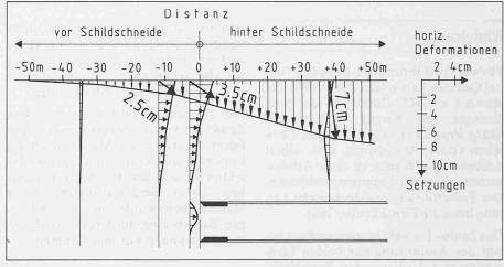
Bild 13. Deformationen in Vortriebsrichtung
