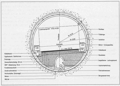
Bild 2. Typischer Tunnelquerschnitt
