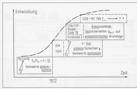
Bild 3. Entwicklungsstufen zur Bemessung von Stahlbetonkonstruktionen
