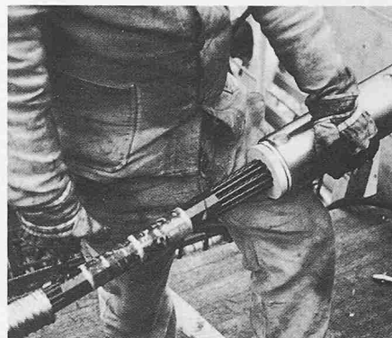
Bild 4. Glasfaserverbundstäbe als Vorspannbewehrung; 600-kN-HLV-Spannglied aus 19 Glasfaserstäben von 7,5 mm Ø
