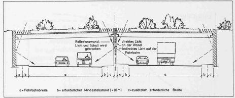
Bild 2. Lärmschutztunnel wie Bild 1 - Querschnitt
