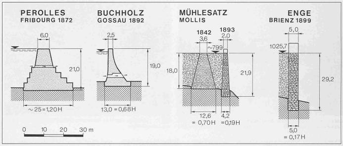
Bild 13. Ouerschnitte der Staumauern Pérolles und Buchholz sowie der Geschieberückhaltesperren Mühlesatz und Enge
