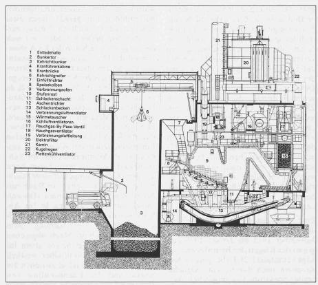
Bild 2. Schnitt durch die Anlage
