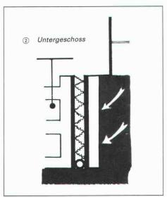
einem dreidimensional strukturierten Sickerkörper aus drahtartigen Polyamid-Fadengelegen mit einer vollflächig aufgeschweissten Spinnvlies-Filterlage aus Polyester auf der einen und einer betonierdichten PVC-Schicht als verlorene Schalung auf der anderen Seite.
