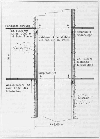
Schematischer Vertikalschnitt durch den Schacht
