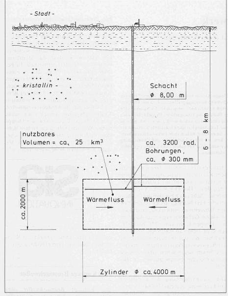
$Schematischer Schnitt \, durch \, die \, Gesamtanlage$
