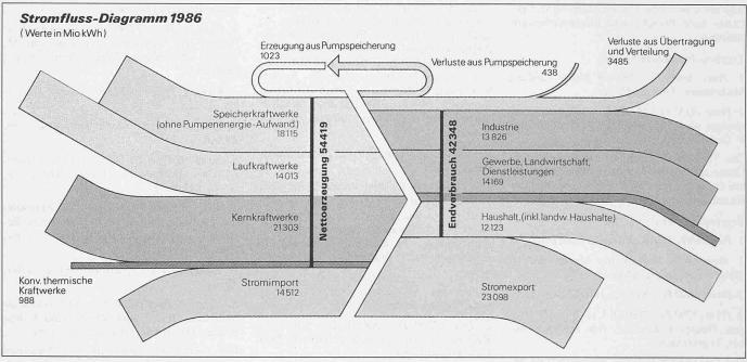
Bild 1. Erzeugung und Verbrauch der elektrischen Energie in der Schweiz
