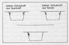
Bild 8. Gelenkschubkräfte aus Querkraft und Zwängungstorsion
