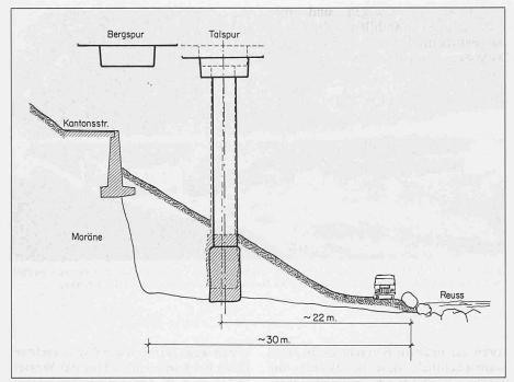
Bild 4. Ouerschnitt durch den Hang im ursprünglichen und erodierten Zustand. Schachtfundament etwa auf Reussufer-Niveau und rund 6 m höher liegende Stützmauerfundamente
