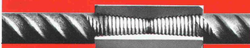
**Das konische Schweizer Fliessgewinde. Für das schnelle Kuppeln von Armierungsstahl. Spanloses Anformen der konischen Gewinde. Hohe Ermüdungsfestigkeit. Baustellen-gerechtes Grob-Gewinde.**
