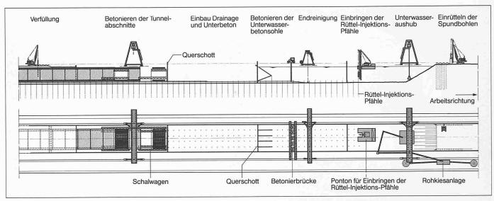
Bild 2. Systematischer Arbeitsablauf Forsttunnels
