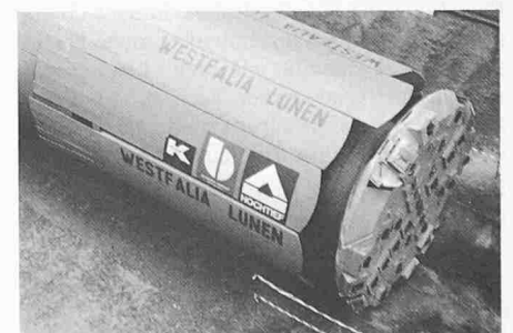
Bild 6. Vollschnittmaschine mit spreizbarem Messerschiff (Erkundungsstollen Freudenstein-Ost)
