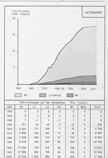
Bild 8. Fahrleistungen auf den Autobahnen
