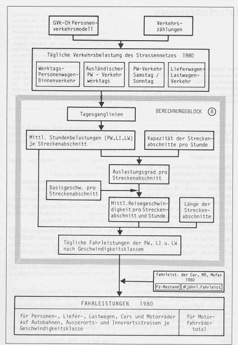
Ablaufschema zur Ermittlung der Fahrleistungen des motorisierten Strassenverkehrs für das Basisiahr 1980
