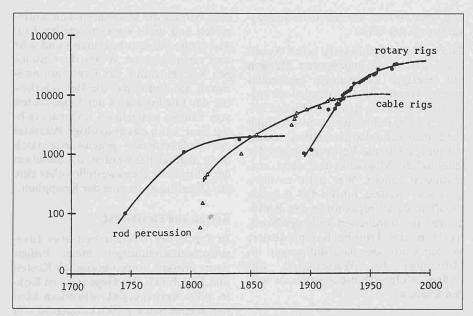
Bild 8. Rekorde in den erzielten Bohrtiefen (in Fuss) verschiedener Bohrtechnologien (Grübler und
