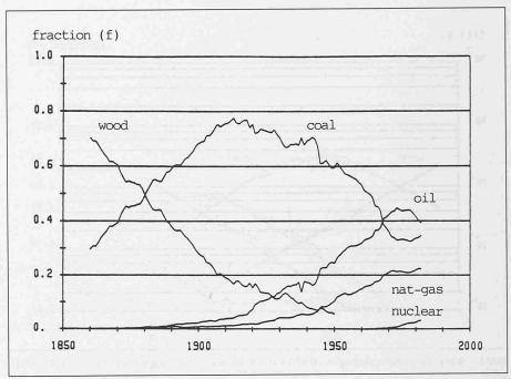
Bild 2. Entwicklung der Anteile einzelner Energieträger am Weltenergieverbrauch (Grübler und Nakicenovic, 1987)  $Anteil (f\ mal\ 100\ ergibt\ den\ Prozentanteil)\ am\ Gesamtenergieverbrauch\ einzelner\ Prim\"{a}renergietr\"{a}ger\ (Holz, normalisetragen))\ and Gesamtenergieverbrauch\ einzelner\ ei$
