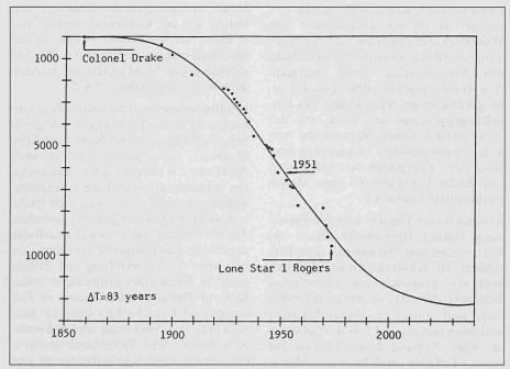
Bild 9. Maximale Teufe von Explorationsbohrungen in den USA (Grübler und Nakicenovic, 1987) Die Hüllkurve (eine logistische Funktion) der technischen Leistungsfähigkeit der Bohrtechnologien aus Abbildung 8 zeigt für die USA, dass in naher Zukunft Bohrtiefen von über 10 000 Metern nicht nur möglich, sondern eher alltäglich sein werden. Dies begünstigt das Auffinden grosser Erdgaslagerstätten. Alle Datenpunkte der Kurve seit 1950 sind übrigens Erdgasbohrungen.
