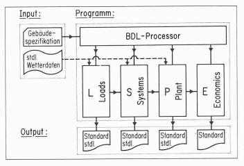
Bild 1. Aufbau des DOE-2-Rechenprogrammes
