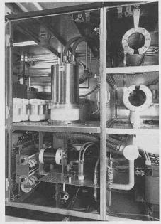
1000-kW-Langwellensender von Brown Boveri -Sicht auf die Treiber- und die Endstufe, letztere bestückt BBC-Hochleistungstetrode mit der CQK 650-1
