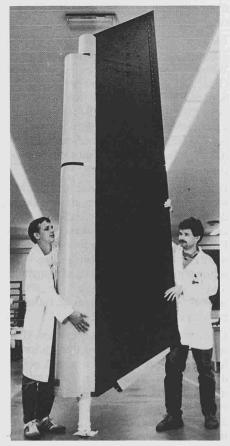
neuen Airbus A320 werden neben dem Seitenleitwerk auch die Landeklappen, das Höhenleitwerk und mehrere andere wichtige Elemente aus CFK bestehen. Verwendet wird hierbei das epoxydharzimprägnierte Kohlenstoffasergewebe Fibredux-Prepregs von Ciba-Geigy.
