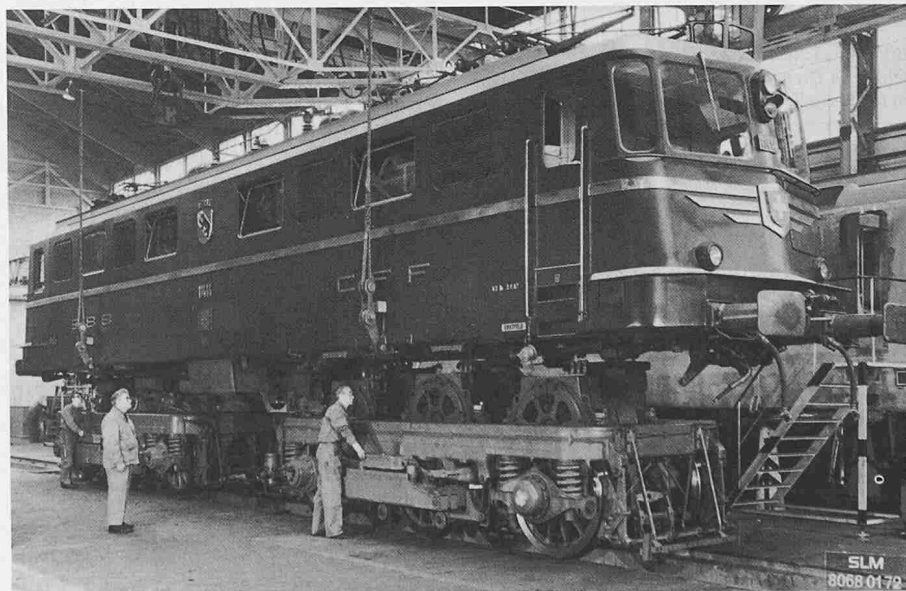
Bild 15. Lokomotive Ae 6/6 Nr. 11414 der SBB, umgebaut für Schnellfahrversuche bis 200 km/h in Deutschland (Foto SLM 1968)
