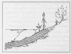
Die Teichsohle wird aus 3 Lagen kalkstabilisiertem Material von je etwa 10 cm Dicke aufgebaut. Dieses Material wird mit Sand und Kies überdeckt und je nach Bedürfnis bepflanzt
