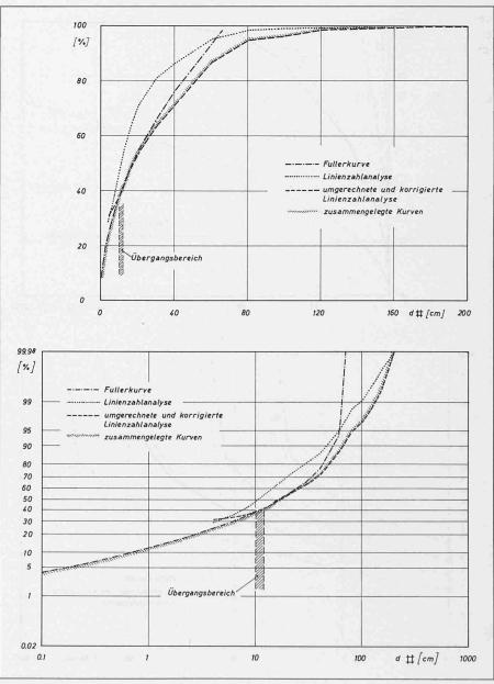
dererseits ist es auch äusserst schwierig, in einem Flussbett Steine mit einem Durchmesser kleiner als 1 cm exakt auf einer Linie zu entnehmen (Breite des ausgelegten Messbandes: 2 cm!). Man wird sehr rasch auch Steine ausmessen, die neben bzw. unter der eigentlichen Linie liegen, und so den Anteil der Feinkomponenten sehr stark überschätzen.
