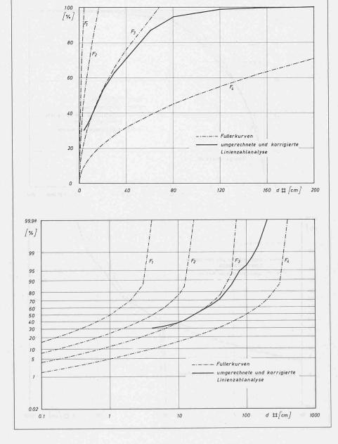
nehmendem Maximalkorndurchmesser immer aufwendiger und beim Auftreten von Körnern grösser als etwa 20 cm praktisch nicht mehr durchführbar (empfohlenes Volumen der zu untersuchenden Probe:  $V[m^3] \ge 2.5 \cdot d_{max}$ [m]; d.h. bei  $d_{max} = 0.20 \text{ m wird } V \ge$ 0,50 m<sup>3</sup>!). Dies führt dazu, dass die groben Komponenten bei der Analyse nicht mehr oder nur ungenau berücksichtigt werden.
