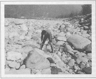
Bild 2. Durchführung einer Linienzahlanalyse mit Hilfe einer «Försterlehre». Eine Schnur bestimmt die auszumessenden Steine
