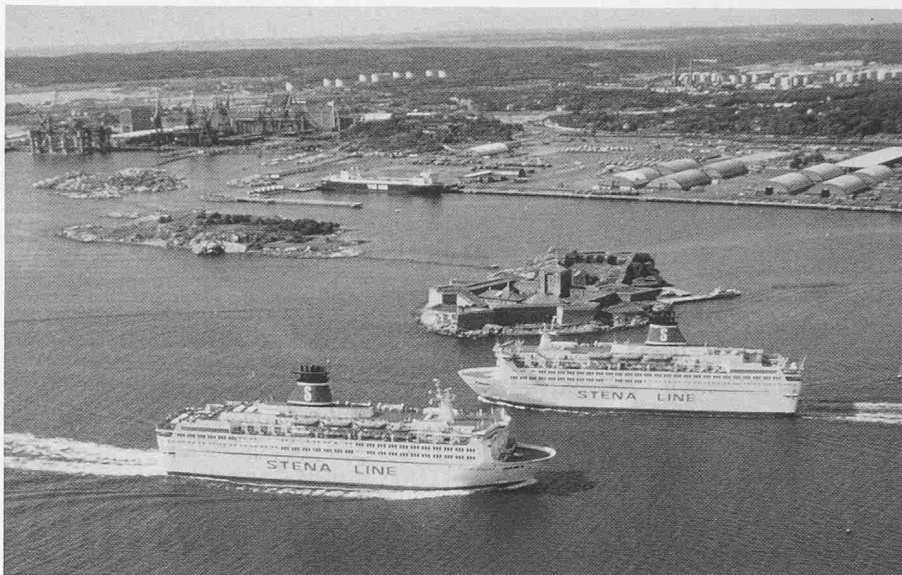
Die beiden dänischen Fähren Stena Danica und Stena Jutlandica für Passagiere und Autos. Beide werden von Viertakt-Dieselmotoren 12 ZV40 von Sulzer mit 25 590 kW (34 800 bhp) Gesamtleistung angetrieben (Werkfoto Sulzer)
