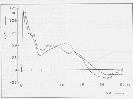
Bild 2. Kraftverlauf beim zerstörenden Stossversuch. Vergleichend sind die Ergebnisse von zwei gleichartigen Platten dargestellt
