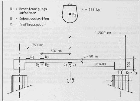
den Projektil soll bis zum Versagen abgeschätzt werden. Dieses Problem kann experimentell kaum an Modellen in wahrer Grösse untersucht werden. Nach einer Reihe von Vorversuchen wurde eine Stahlbetonplatte mit einem Durchmesser von 2 m und einer Dicke von 50 mm als Modell gewählt. Es zeigte sich, dass Mikrobeton mit folgender Zusammensetzung brauchbare mechanische Eigenschaften aufweist:
