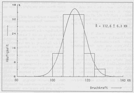
Bild 4. Häufigkeitsverteilung der Bruchkraft, gemessen an 23 Platten
