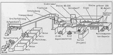
Materialfluss-Darstellung der Bauschutt-Sortieranlage in Allschwil
