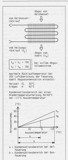
Bild 3. Kondensationsbereich bei Öl- und Gasfeuerung
