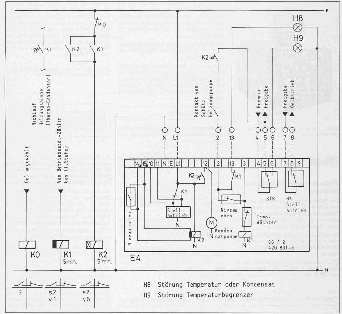
Bild 5. Sicherheitskette der Steuerung (Werkbild Hoval)
