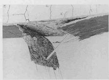
Bild 3. Bruchbild der 0,3 mm dicken CFK-Lamelle nach Erreichen der Maximallast. Dank einer ausgezeichneten Epoxidharz-Verklebung zwischen Beton und Lamelle gelingt es, die hohen Festigkeiten dieses Werkstoffes voll auszuschöpfen.
