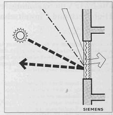
Bild 5. Prismensysteme zur Tageslichtnutzung
