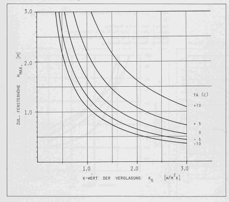
□ Einfluss der Fenstergrösse und des k-Wertes auf die resultierende mittlere Strahlungstemperatur. Damit die Winter-Komfortbedingungen gemäss Tabelle 2 eingehalten werden können, muss bei einer Raumlufttemperatur von 20 °C die mittlere Strahlungstemperatur 18,5 °C betragen. In Bild 2 sind der zulässige Fensterflächen-Anteil in Abhängigkeit des k-Wertes des Fensters für 4 verschiedene Situationen angegeben, basierend auf den Randbedingungen, wie sie in der SIA-Empfehlung 384/2 formuliert sind.
