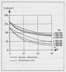
Bild 1. Energiebedarf für Beleuchtung während der Heizsaison in Abhängigkeit des Fensterflächenanteils und der Ein- und Ausschaltschwellen. links = Büro: rechts = Wohnraum
