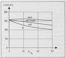
Annahmen: - 2 IV Wärmeschutzglas - Schwere Konstruktion mit Nachtabsenkung - Klima Genf -Orientierung Süd
