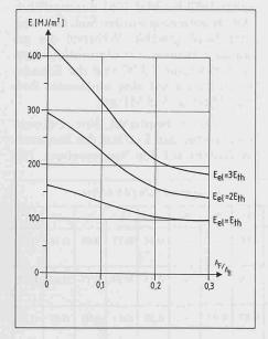
Bild 3. Gesamtenergiebedarf während der Heizperiode in Abhängigkeit des Fensterflächenanteils und der Orientierung. links = Büro; rechts = Wohnraum
