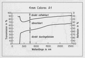
Bild 5. Aufteilung der auftreffenden Globalstrahlung für ein Sonnenschutzglas
