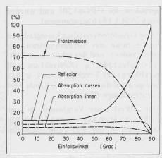
Bild 3. Einfluss des Einfallwinkels auf den Strahlungsdurchgang einer 2-fach-Verglasung (Klarglas)
