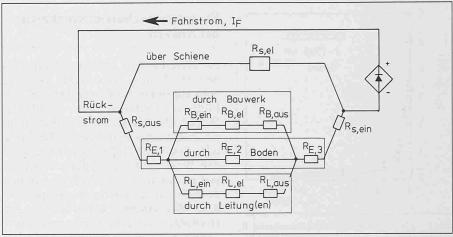
Bild 2. Vereinfachtes Prinzipschema des Steustromflusses von den Schienen (Index S) duch ein Bauwerk (Index B), eine Leitung (Index L) und durch die Erde (Index E). Die Aus-bzw. Eintrittswiderstände sind mit  $R_{aus}$  bzw.  $R_{ein}$ , die Widerstände der elektrischen Leitung mit  $R_{el}$  gekennzeichnet. Die elektrochemischen Widerstände  $R_{aus}$  und  $R_{ein}$  verhalten sich nicht rein ohm'sch
