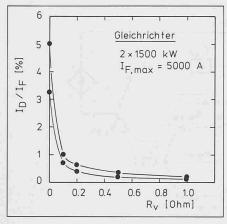
Bild 3. Einfluss eines Vorschaltwiderstandes  $R_V$  auf den Streustromfluss bei einer gerichteten Streustrom-Drainage in Oerlikon ( $I_D$  = Drainagestrom,  $I_F$  = Fahrstrom aus Gleichrichter). Bei einer Streustrom-Drainage werden die Widerstände  $R_{B, aus}$  bzw.  $R_{L, aus}$  und  $R_{E, 3}$  sowie  $R_{S, ein}$  (s. Bild 2) durch einen niederohmigen elektrischen Leiter überbrückt (siehe [10])
