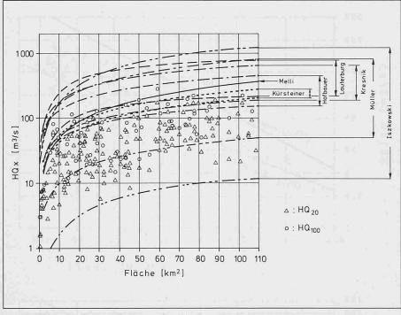
Bild 3. Schätzungsresultate für Höchstwasserabflüsse nach Formeln verschiedener Autoren
