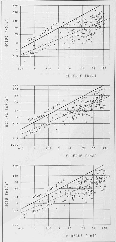
Bild 2a-c. 2,33-, 20- und 100jährliche Hochwasserabflüsse als Funktion der Einzugsgebietsfläche. Die Umhüllende gibt den maximal zu erwartenden Abfluss der betreffenden Jährlichkeit an
