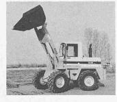
Lader mit einem wassergekühlten Perkins-Vierzylinder-Diesel haben oder mit einem luftgekühlten Deutz in gleicher Bauart. Beide leisten 54 kW bzw. 74 PS 2,200 U/min.
