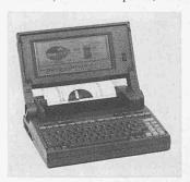
teriebetrieb bis zu 4 Stunden und Kommunikationsfähigkeit. Alles zusammen wiegt nur 6,5 Kilo und lässt sich in der mitgelieferten Tragtasche über die Schulter gehängt bequem transportieren. Der LapTop (Ausmasse 30,2×35,5 cm) ist nach eingehender Bedarfsforschung für Berufe konzipiert, in denen wechselnd auf Reisen, zuhause oder im Büro gearbeitet wird.
