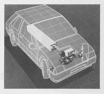
Bild 4. Anordnung der Hochenergiebatterie und des Antriebs in einem Serienwagen (Fotos und Grafiken: BBC)
