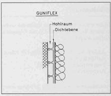
Bild 2. Längsstege bilden den Drainage-Hohlraum
