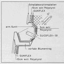
Bild 6. Wärmedämmung
