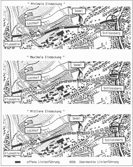
Bild 1. Varianten im Bereich Fluhmühle-Schlossberg: bei weitgehend gleicher Linienführung bedeutende Unterschiede in den Anteilen offen und überdeckt geführter Abschnitte
