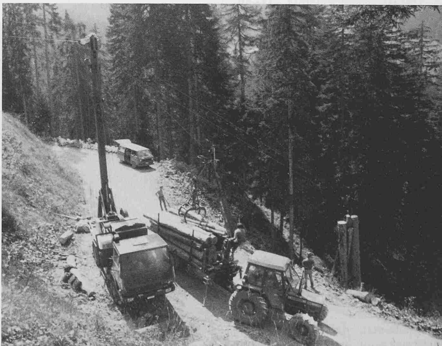
Bild 1. Der K-600 SANASILVA beim Bergauftransport von Trümmern aus einer Zwangsnutzung im Gebirgswald
