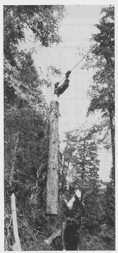
Bild 2. Für einen bestandesschonenden Bergabtransport bewährt sich das beim K-600 verwendete Seilsystem mit dem abgebildeten Laufwagen besonders gut
