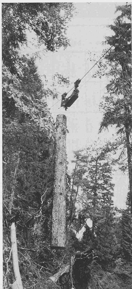
Bild 2. Für einen bestandesschonenden Bergabtransport bewährt sich das beim K-600 verwendete Seilsystem mit dem abgebildeten Laufwagen besonders gut
