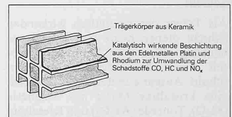
Bild 6. Wabenstruktur; 1 Trägerkörper aus Keramik, 2 katalytisch wirkende Beschichtung aus den Edelmetallen Platin und Rhodium zur Umwandlung der Schadstoffe CO, HC und NO x
