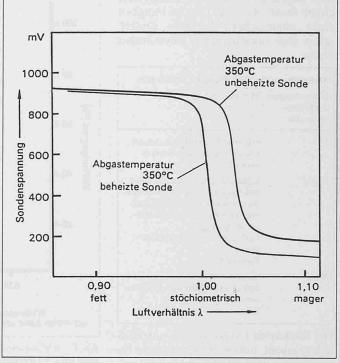
Bild 11. Spannung einer beheizten Lambda-Sonde im Vergleich zu derjenigen
