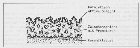
Bild 7. Oberfläche des Katalysators; 1 katalytisch aktive Schicht, 2 Zwischenschicht mit Promotoren, 3 Keramikträger
