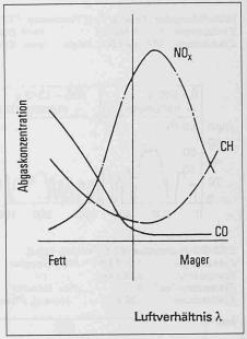
Bild 1. Abgaskonzentration in Abhängigkeit vom Luftverhältnis
