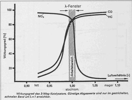
Bild 5. Wirkungsgrad des Dreiweg-Katalysators (günstige Abgaswerte sind nur im gestrichelten schmalen  $Bandum\lambda = 1 erreichbar)$
