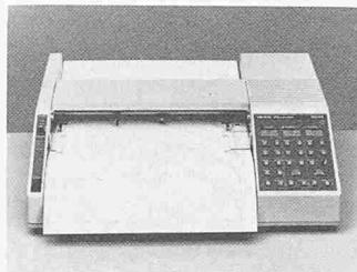
kleine Empfindlichkeit führt andererseits zu einer ungenügenden Auflösung. Die Lösung wurde in einer automatischen Nullpunktverschiebung von bis zu 500% gefunden.
