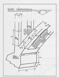
Bild 4. Skizze Kämpferbereich mit Sprengschnitten
