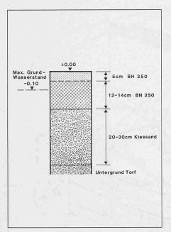
Bild 6. Kantonsstrasse Höri-Riet (ZH); Untergrund und Strassenoberbau
