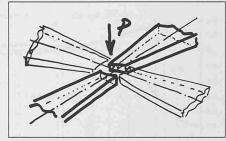
Bild 2. Keilförmige, orthogonal sich kreuzende Plattenstreifen
