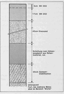
Bild 8. Autobahn N3 (SG) Flums-Heiligkreuz; Untergrund und Strassenoberbau
