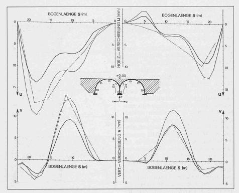
Tunnel Maria Zell; Verschiebungskomponenten u und v der Biegelinie; Hinterfüllung bis zum Scheitel. Berechnung: akt. Erddruck -- Ruhedruck --Messung · - ·
