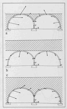
Tunnel Maria Zell, Bogenverformungen bei der Auffüllung bis zum Scheitel (a), differentielle (b), und totale Verformungen bei der endgültigen Aufschüttung (c)
