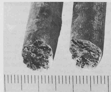
Bild 2. Gebrochene Bügel, mit der für spannungsrissskorrosionstypischen, verformungsarmen Bruchfläche, führten 1985 zum Deckeneinsturz im Hallenbad Uster (Vgl. «Schweizer Ingenieur und Architekt», H. 23/85, S. 566 und H. 8/87, S. 184)
