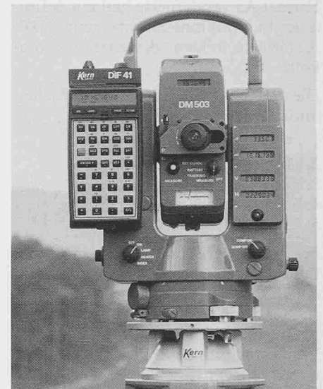
Bild 4. Elektronischer Tachymeter bestehend aus elektronischem Theodoliten, elektronischem Distanzmessgerät und Registriergerät
