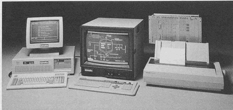
Bild 4. Die PC sind sehr leistungsfähig geworden. Das Mikro-Leitsystem MLS besteht aus IBM-PC/AT, Grafik-Prozessor, Standard-Industriemonitor und Drucker. Für den Anschluss von unterlagerten PLCs stehen Protokolle zu den wichtigsten Herstellern zur Verfügung.
