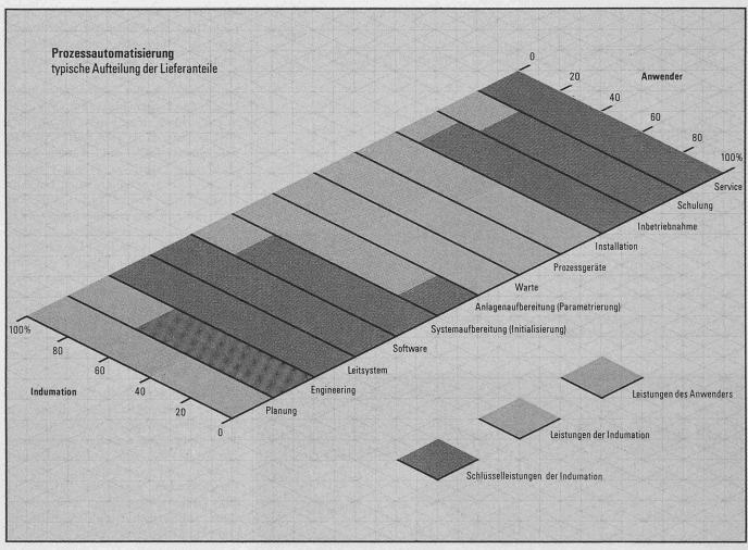
Bild 1. Typische Aufteilung der Leistungen in einem Engineering-Auftrag am Beispiel der Indumation
