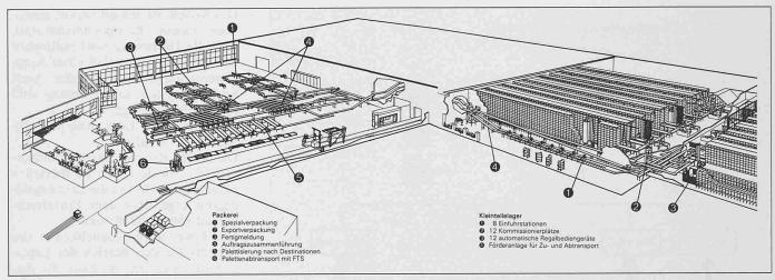
Bild 8. Ein vollautomatisches, rechnergesteuertes Hochregallager stellt ein komplexes technisches System dar. Im Bild das Verteilzentrum «Elcoma» von Philips
