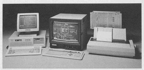
Bild 4. Die PC sind sehr leistungsfähig geworden. Das Mikroleitsystem MLS besteht aus IBM-PC/AT, Grafik-Prozessor, Standard-Industriemonitor und Drucker. Für den Anschluss von unterlagerten PLCs stehen Protokolle zu den wichtigsten Herstellern zur Verfügung
