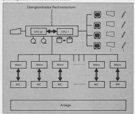
fehlerfrei und ohne Datenverlust weiterarbeitet, wenn eine beliebige Hardware-Komponente ausfällt. Das System wurde zum vornherein als ausfallsicheres Mehrrechnersystem konzipiert, dies im Gegensatz zu einem konventionellen Duplex-System, das aus der Parallelschaltung von zwei Einfach-Systemen entsteht.
