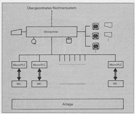
Bild 10. Mittlere Konzeptlinie, als zentraler Lagerrechner werden hier PDP- und VAX-Systeme von Digital Equipment eingesetzt. Das Konzept ist allgemein gültig und kann auch für die Führung eines komplexeren Fabrikationsprozesses eingesetzt werden
