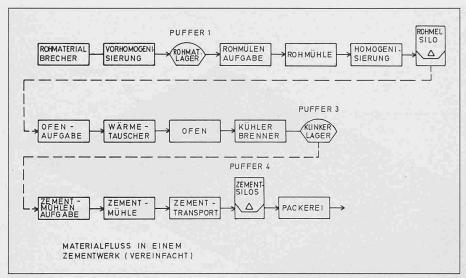
Bild 3. Schematische Darstellung des Materialflusses in einem Zementwerk. Die vier Puffer ermöglichen eine wirkungsvolle Entkoppelung der wesentlichen Produktionsabschnitte. Die Empfindlichkeit des Systems auf Störungen und Wartungsunterbrüche ist damit wesentlich reduziert
